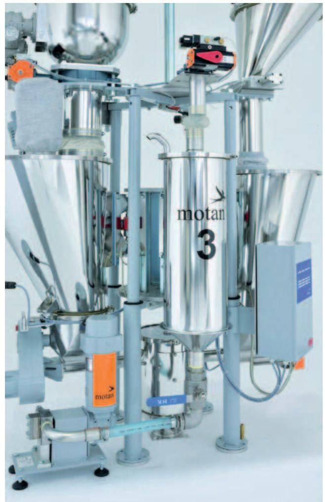
Dosiersystem für den Extrusions- und Compoundierbereich
