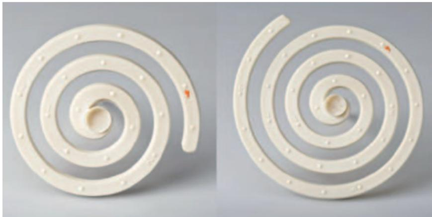
Verbesserung der Fließfähigkeit durch geeigneten Polymerblend am Beispiel hochgefüllter wärmeleitender Compounds. Der Spiraltest zeigt rechts eine deutlich erhöhte Fließlänge gegenüber einem kommerziell verfügbaren Compound
