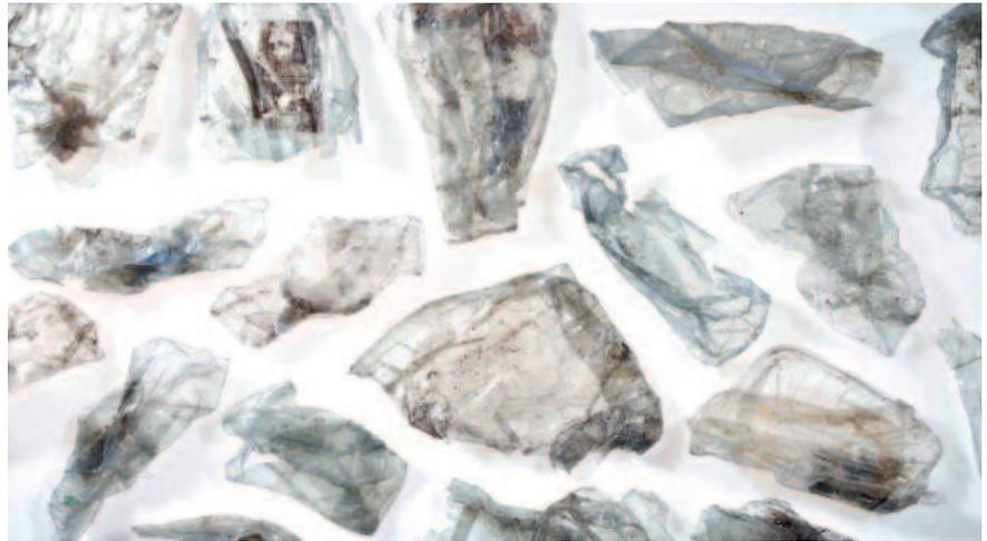
PET-Schalen weisen oft komplexe Designs und Zusammensetzungen auf, die das Sortieren und die Dekontamination erschweren
