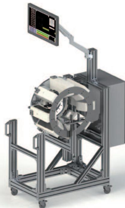
ProfilControl 7 RubberFlex ist für die hohen Qualitätsanforderungen im Automotive-Sektor gerüstet und meistert die Qualitätskontrolle von elastischen, variablen und filigranen Gummiprofilen von einfacher bis mittlerer Komplexität
