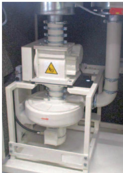
Stellvertretend für sein Angebot an Guillotinen präsentiert GETECHA auf der K eine GH 300 für die Vorzerkleinerung von Randbeschnitten aus der Extrusion. Deren Frequenzumrichter erlaubt es, die Hubzahl an die Liniengeschwindigkeit anzupassen. Die Guillotinen gibt es mit verschiedenen Schnittbreiten sowohl mit elektrischen Antrieben als auch in einer hydraulischen Variante, mit der sich selbst mehrere Zentimeter dicke POM- und HDPE-Reste aus der Plattenextrusion zuverlässig vorschneiden lassen.
