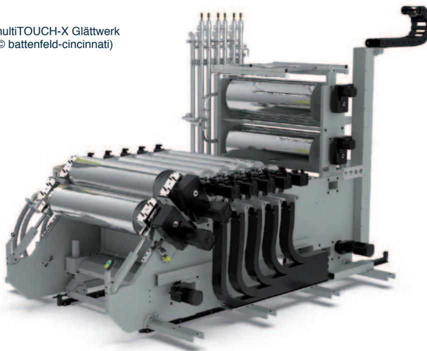
zueinander laufen, sondern leicht versetzt sind, wird eine etwaige Walzendurchbiegung kompensiert. Der gleichmäßige Spalt über einen großen Betriebsbereich erlaubt die Herstellung der besonders dünnen Folien.
